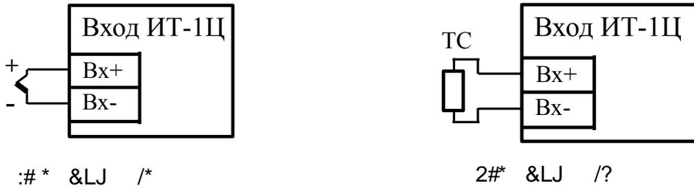
Рисунок С.1 - Подключение чувствительного элемента в ИТ-1Ц.А, ИТ-1Ц.Б, ИТ-1Ц.Г
