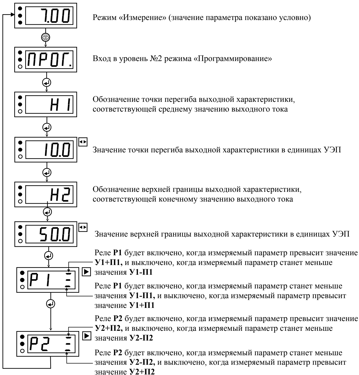
Рисунок Е.1 – Блок-схема алгоритма работы ИП в режиме «Программирование» УРОВЕНЬ 1
