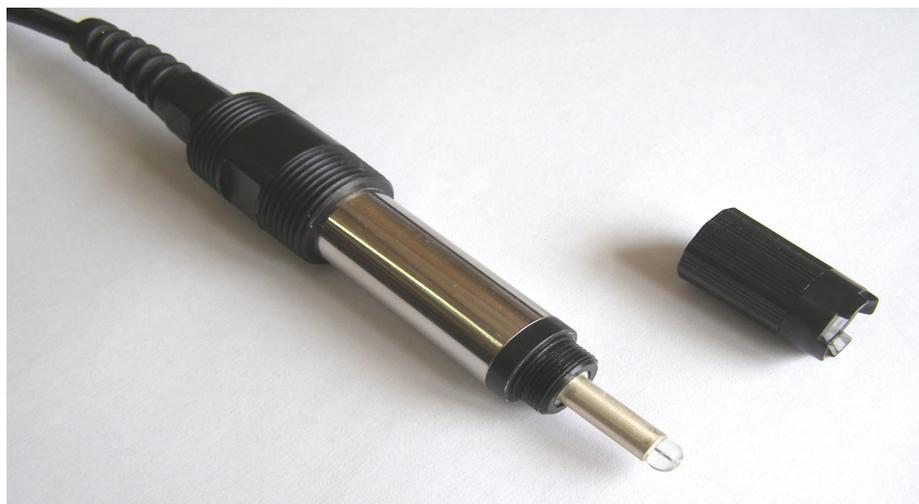
Рисунок 6 - Датчик кислорода со снятым мембранным картриджем
