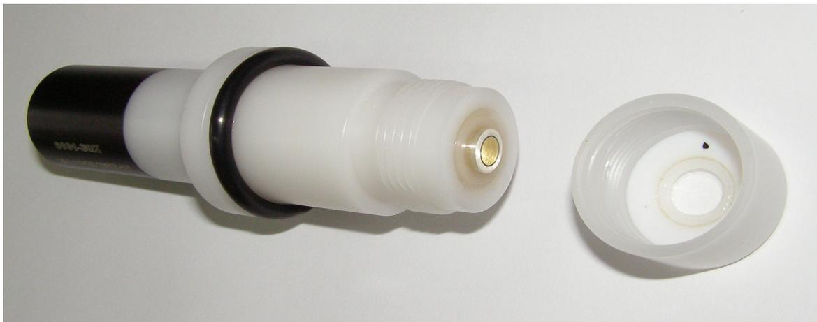
Рисунок 3 - Датчик кислорода со снятым мембранным картриджем
