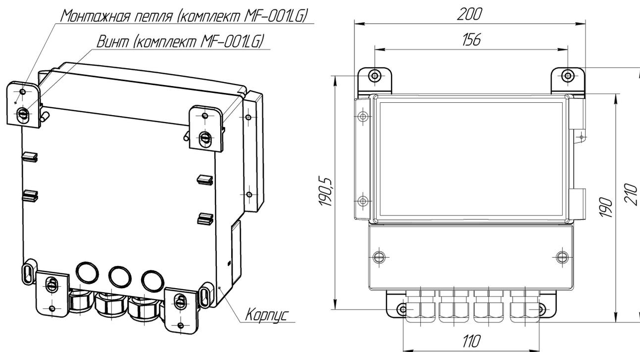
Рисунок А.3 Крепление измерительного прибора настенного исполнения при помощи монтажных петель.
