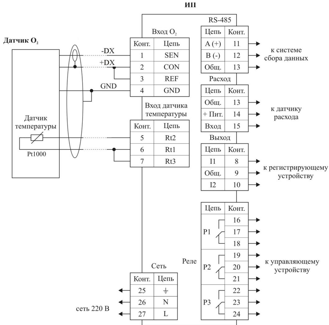
Рисунок С.1 - Схема подключений амперометрического датчика растворенного кислорода к измерительному преобразователю
