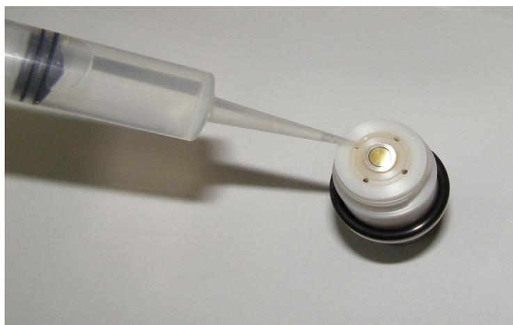
Рисунок 5 - Заливка электролита в датчик
