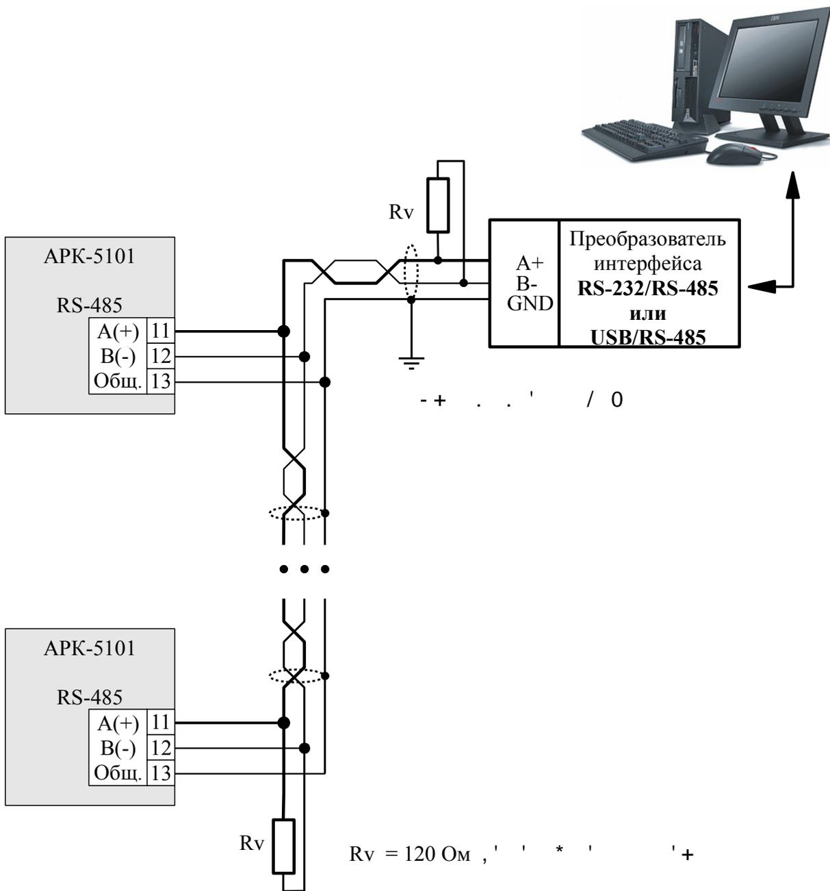
Рисунок С.3 - Включение приборов с интерфейсом RS-485 в локальную сеть
