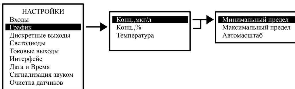
В этом режиме выбираются параметры масштабирования для каждого измеряемого параметра: Конц.О2, мкг/л, Конц.О2, %, Температура. Для каждого параметра выбираются минимальный и максимальный пределы для вывода тренда на индикатор. Или может быть выбран режим автомасштабирования.
