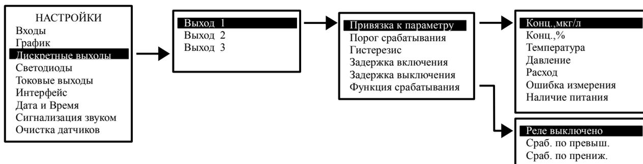
В этом режиме программируются три дискретных выхода (реле), порог срабатывания, гистерезис, задержки включения и выключения, функция срабатывания и привязка к параметру.
