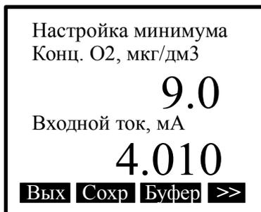
Для изменения значения измеряемого контрольного раствора, нажать кнопку **Буфер**.
