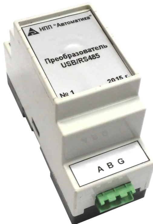
Рисунок D.2 - Преобразователь интерфейса USB-RS485
