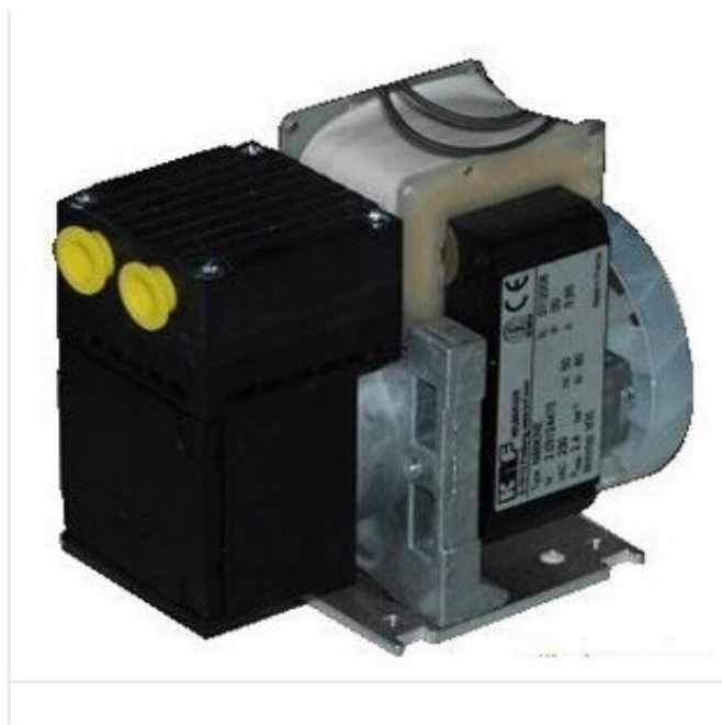
Рисунок D.16 - Компрессор для очистки погружных датчиков (~220 VAC, 60 W, давление до 2,4 бар, расход воздуха до 6 л/мин, габариты 103×93×64 мм)
