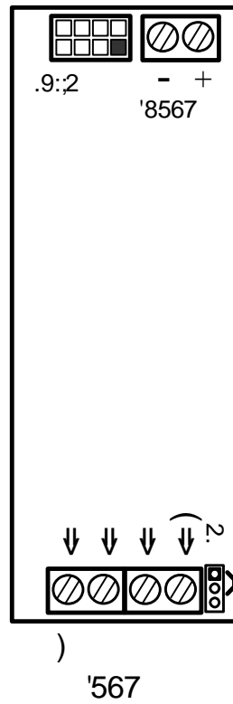
Рисунок Б.8 - Расположение клемм и разъёма для подключения пульта программирования на плате преобразователя НПТ-2Ц.Р.0.42
