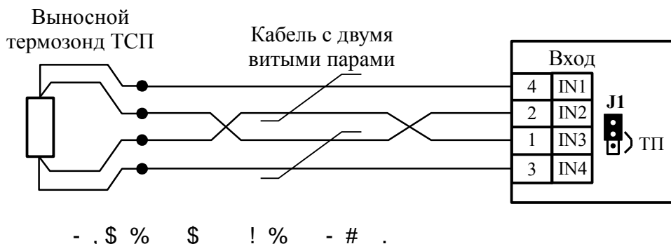
Рисунок В.3 - Подключение термометра сопротивления к НПТ-1Ц.В(ВИ), НПТ-2Ц.В(ВИ), НПТ-1Ц.П(ПИ), НПТ-2Ц.П(ПИ), НПТ-2Ц.Р (Перемычка J1 отсутствует или установлена не в положение «ТП»)
