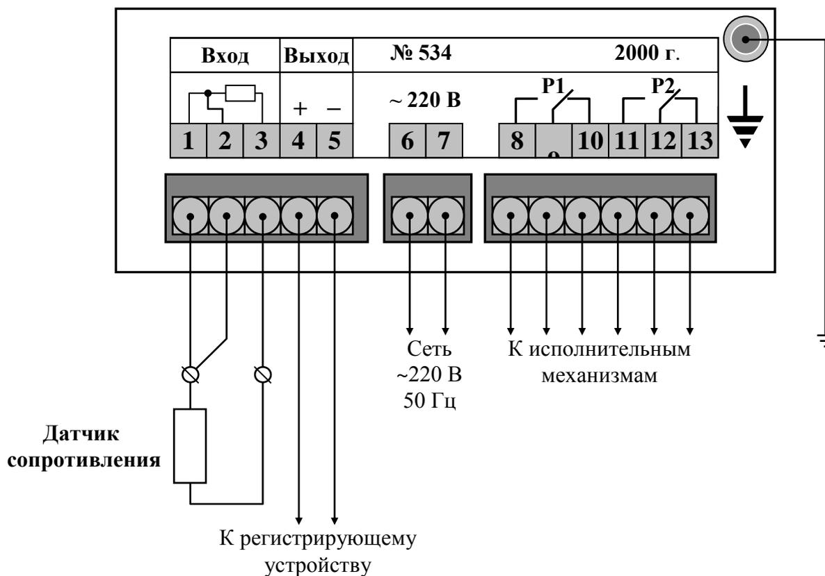
Рисунок Б.5 - Подключение резистивного датчика к ПКЦ-1101.С
