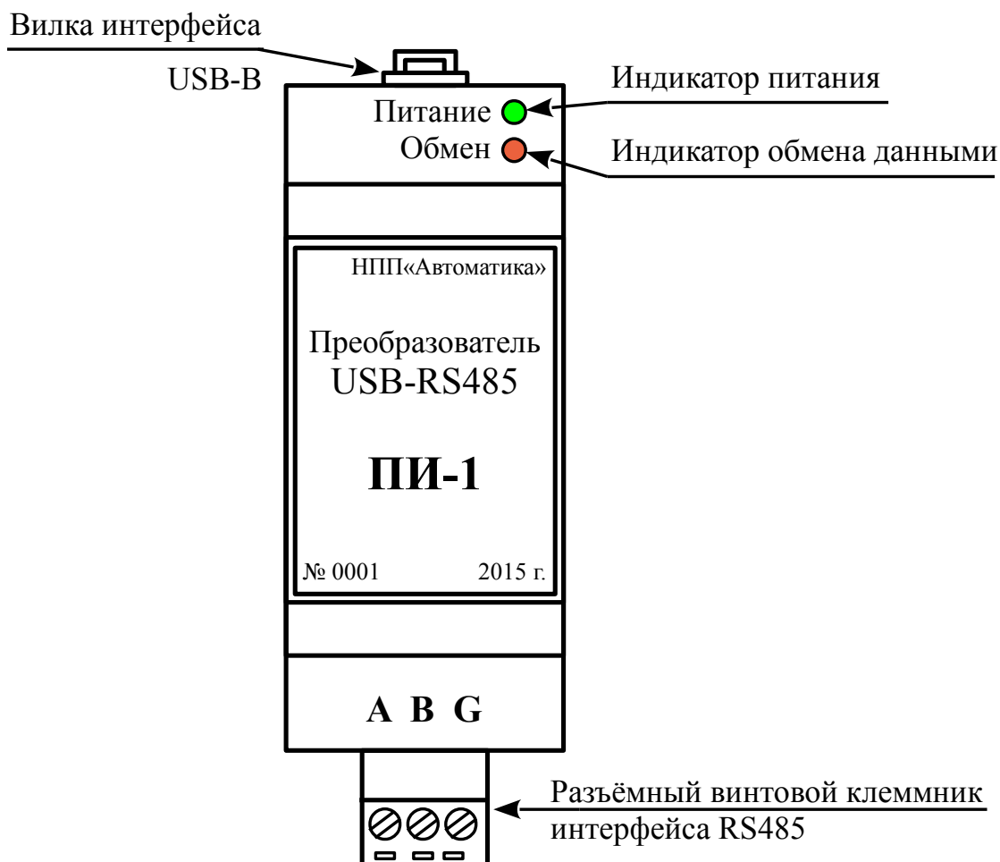
Рисунок 4 - Расположение индикаторов и разъёмов
